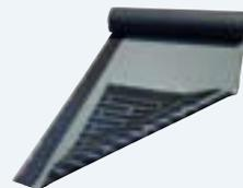
裏面がストライプ状の粘着層になっており、通気層と防水層の機能を持つハイブリッド改質アスファルトシート。シートジョイント部のみ炙るタイプのシートです。
